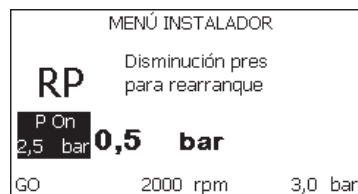
Figura 17: Configuración de la presión de reencendido
